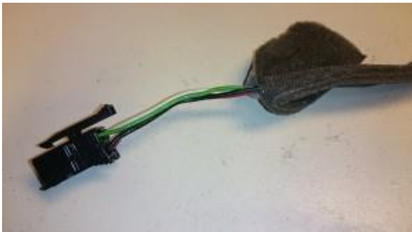
Anslutning för AEM, bakom lucka vid golvet till höger i bagage.
